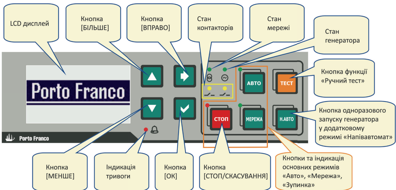
Рис. 5.2 – Панель індикації та управління
